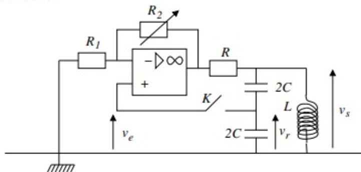
1. L'interrupteur  $K$  étant ouvert, calculer les fonctions de transfert :
