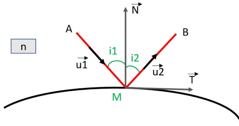
On note à nouveau  $\vec{u}_1$  et  $\vec{u}_2$  les vecteurs directeurs unitaires de AM et MB.  $\vec{N}$  est toujours selon la normale au dioptre et  $\vec{T}$  selon sa tangente. De même il l'angle (algébrique) entre AM et la normale au dioptre, ainsi que  $i_2$  celui entre MB et la normale au dioptre
