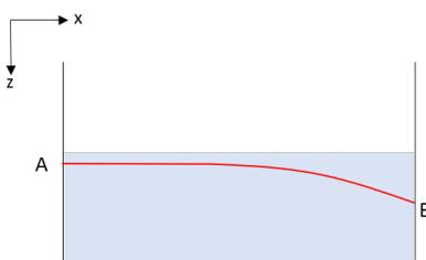
Comme l'indice optique dépend de la densité, et que cette dernière ne dépend (à priori) que de la profondeur dans la cuve, on suppose que  $n = n(z)$
