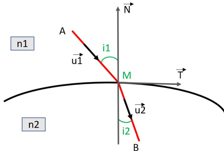
La lumière va de A à B, en se réfractant sur le dioptre en M. Les points A et B sont fixes. On note  $\vec{u}_1$  et  $\vec{u}_2$  les vecteurs directeurs unitaires de AM et MB.  $\vec{N}$  est selon la normale au dioptre et  $\vec{T}$  selon sa tangente. On note  $i_1$  l'angle (algébrique) entre AM et la normale au dioptre, ainsi que  $i_2$  celui entre MB et la normale au dioptre
