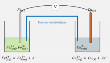
Si on mesure une tension entre deux points, cela signifie que ces deux points ont un potentiel différent. Ainsi chaque demi-pile possède son propre potentiel.
